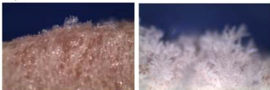
Figura 1. Diferencias morfológicas de la escarcha determinadas en las muestras al inicio del estudio. a) Congelación en cámara. b) Congelación con N 2 líquido.
